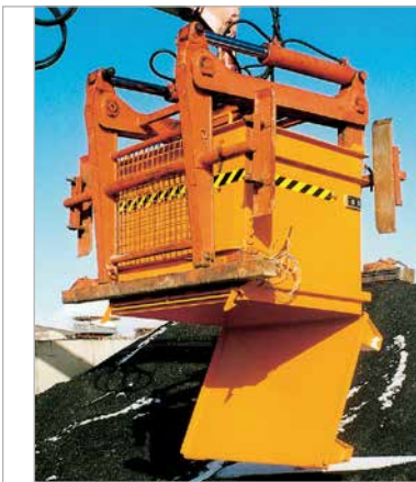
BC mit Steinklammer-Entriegelung
