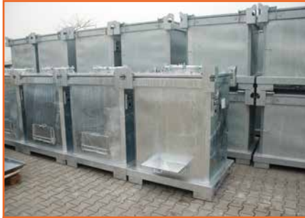
Sonderabfall-Behälter 152-156 (für flüssige Stoffe)
