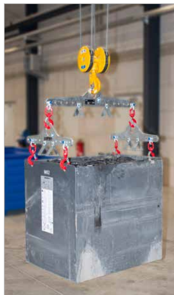
Kombination aus mehreren Traversen zur H-Traverse
