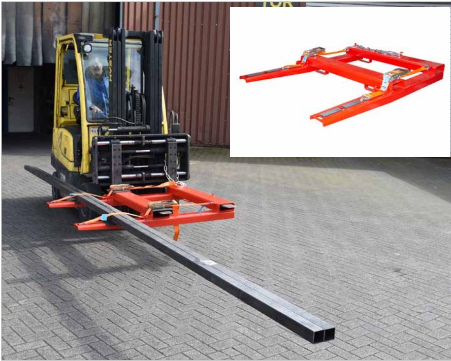
Aufnahmeposition zum Transport z.B. durch Tore oder Gänge
